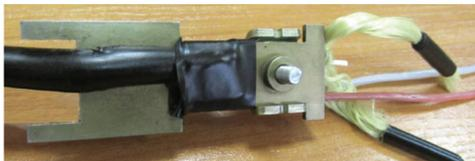
**8.11** Продвинуть смонтированный с кронштейном ЦСЭ ОК по направлению к патрубку, вставить в пазы (рисунок «а») и продвинуть до упора (рисунок «б»).
