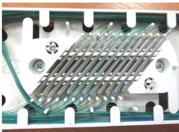
*Примечание – В гнезда ложемента установку смонтированных сварных соединений ОВ, защищенных КДЭС-4525, производить поочередно, учитывая нумерацию ОВ и условную нумерацию гнезд ложемента. При размещении в гнезде ложемента менее 4 сростков ОВ свободные места заполнить усаженными КДЭС-4525.*
