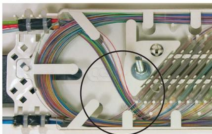
**12.2** Условно распределить ложемент кассеты на 4 группы, каждая из которых содержит 3 гнезда. Укладывать ОВ монтируемых ОМ в среднее гнездо группы, в которых будут размещаться сварные соединения этих ОВ, и обрезать ОВ посередине гнезда ложемента.
