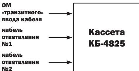
**10** Выполнить ввод на катушку монтируемых ОМ «транзитного» ввода кабеля направления «А»
