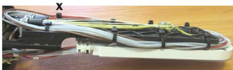
**X** – место фиксации «транзитных» петель ОМ на металлическом кронштейне
