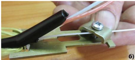
**8.8** Завести пучки арамидных нитей между скобой и пластиной на разные стороны относительно винта крепления параллельно друг другу.
